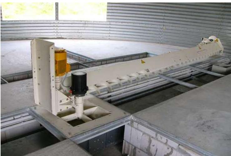
Die Schnecken sind mit Schleifring und E- Motor, stabiler Trägereinheit im Silozentrum, Zwischenlager und Schutzblech sowie einem Spezial-Fegeschneckenvortrieb am Ende ausgestattet, Ausführung in lackiert.
